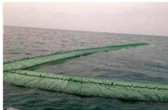
شکل-۳. لوله پلاستیکی (مشک ماری) حمل حمل و نقل دریایی سوخت از خشکی به دریا
